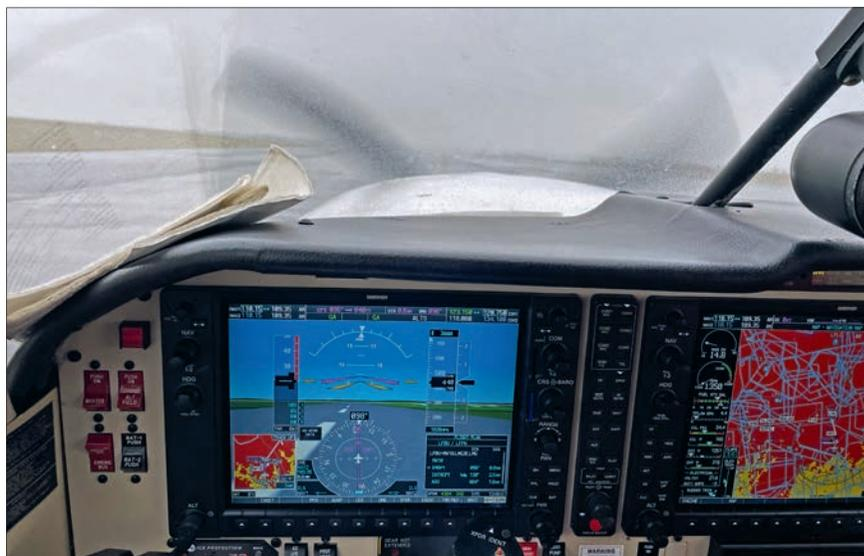
tique ; montre/chrono, montre poignet acceptée si indique heures/minutes/secondes ; altimètre en ft, calage hPa/mb ; anémomètre ; vario (Vertical Speed Indicator) ; bille/aiguille ou taux, de virage ; horizon artificiel ; conservateur de cap (de préférence avec une « pinnule ») ; OAT (Outside Air Temperature) ; une source de pression statique alternative ; un dispositif indiquant si l'alimentation des instruments gyroscopiques n'est pas adéquate ; réchauffe Pitot.
